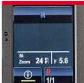
**Display:** Der Metz-Blitz wird über einen farbigen Touchscreen bedient.
