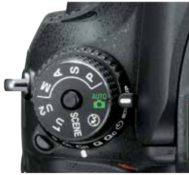
Die Moduswahlräder der Vollformatkameras EOS 6D und D610 rücken wegen des oberen Info-Displays von der rechten auf die linke Seite des Sucherbuckels und sind im Gegensatz zu denen der Einsteigermodelle EOS 700D und D5300 per Arretierung gesichert.
