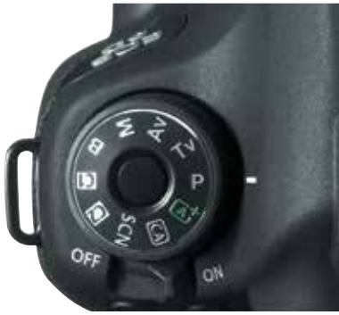
Die Moduswahlräder der Vollformatkameras EOS 6D und D610 rücken wegen des oberen Info-Displays von der rechten auf die linke Seite des Sucherbuckels und sind im Gegensatz zu denen der Einsteigermodelle EOS 700D und D5300 per Arretierung gesichert.
