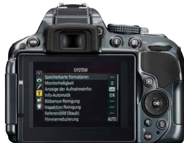
Nikon hat das D5200-Bedienkonzept beibehalten und Bedienelemente an der Kameraober- und Kamerarückseite sowie links angebracht. Mit der Menütaste links neben dem Sucher gelangt man ins Hauptmenü. Mit dem Vierwegetaster können die Unterbereiche durchtastet werden, darunter auch das Untermenü „System“.
