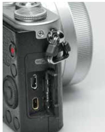
Die Seitenansicht offenbart das schlanke Profil der Lumix GM1. Hinter der Klappe auf der rechten Seite verstecken sich die Anschlüsse für HDMI (oben) und AV OUT/ Digital (USB 2.0).
