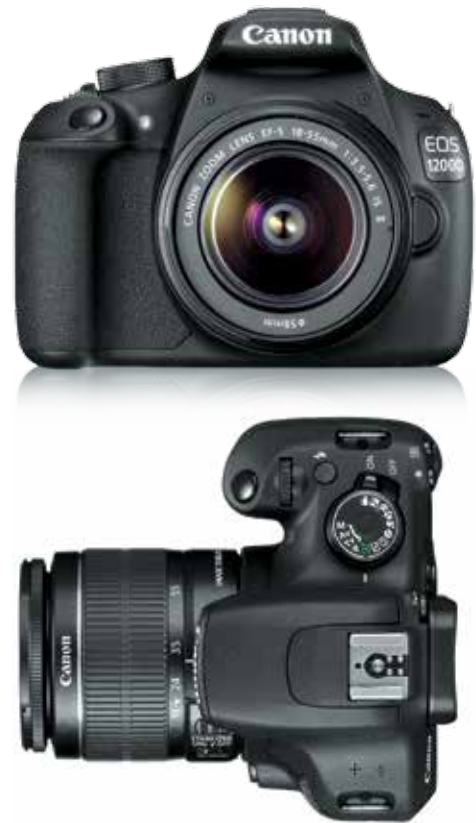
Sämtliche Bedienelemente an der Oberseite konzentrieren sich auf die rechte Gehäusehälfte.
