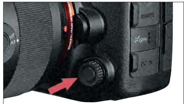
Die A99 hat ein eingebautes GPS-Modul (rechts). Der Multi-Controller (Pfeil), ein lautlos arbeitendes Drehrad mit Bestätigungstaste, schafft eine zusätzliche Einstellenebene.
