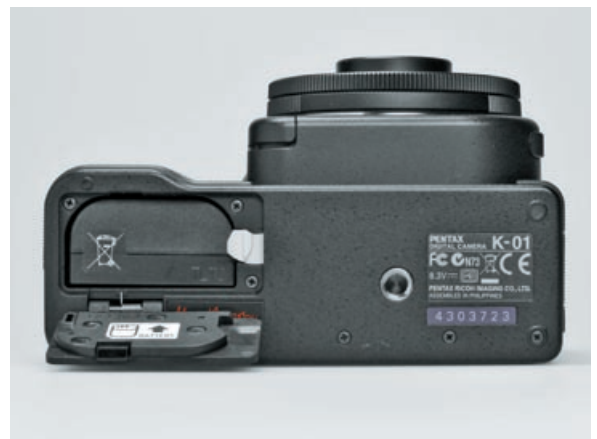
In der K-01 hat der große Li-Ionen-Akku D-LI90 das Bodenfach für sich allein. Es ist der gleiche Akku-Typ wie in der K-5, und seine Kapazität soll für gut 500 Bilder reichen.
