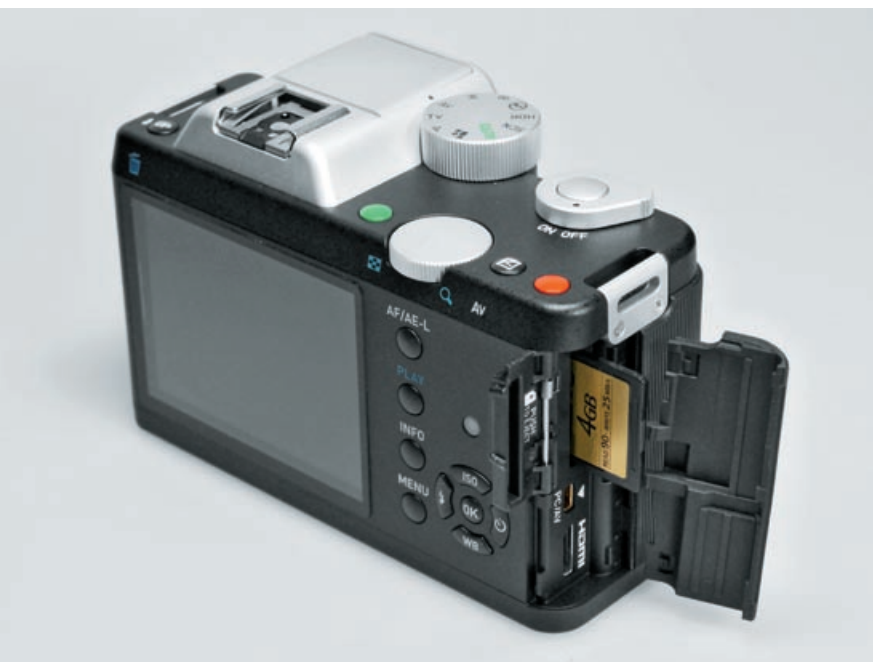
Eine Gummiklappe deckt bei der K-01 Anschlüsse und Speicherkartenfach ab, das von einer kleinen Innenklappe zusätzlich geschützt wird.
