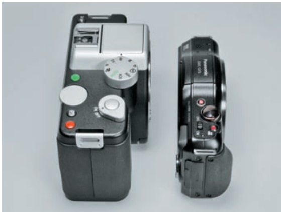
Das unveränderte Auflagemaß der Pentax K-01 erlaubt die Verwendung vorhandener K-Bajonett-Objektive, macht die Kamera aber dick.
