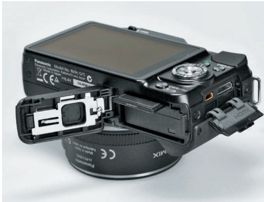
Speicherkarten und Akkufach liegen wie gewohnt im Boden der Lumix GF5, USB- und HDMI-Anschlüsse hinter der seitlichen Klappe.
