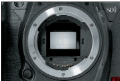
Wie die SD1 ist die SD1 Merrill mit dem dreischichtigen Foveon-Sensor im APS-C-Format ausgestattet, der eine sehr hohe Farbauflösung ermöglicht.
