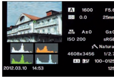
Bei der Bildwiedergabe lässt sich ein RGB-Luminanz-Histogramm anzeigen – daneben die wichtigsten Aufnahmeparameter der Bilddatei.
