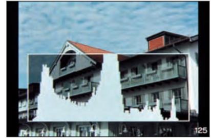
Alternativ zum RGB-Histogramm lässt sich das Luminanz-Histogramm großflächig anzeigen, was in bestimmten Situationen praktisch ist.
