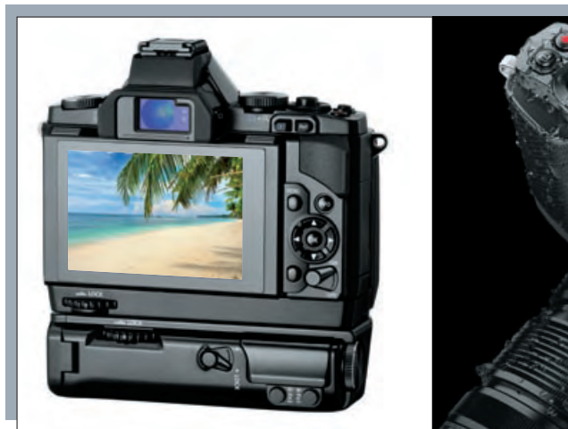
Das leuchtstarke AMOLED-Display und das spritzwassergeschützte Gehäuse gehören zu den Pluspunkten der OM-D. Die programmierbaren Schnellzugriffstasten FN1 und FN2 sind allerdings nach der Aufnahme gesperrt, bis die Kamera das Bild oder die Bildserie auf die Karte geschrieben hat.
