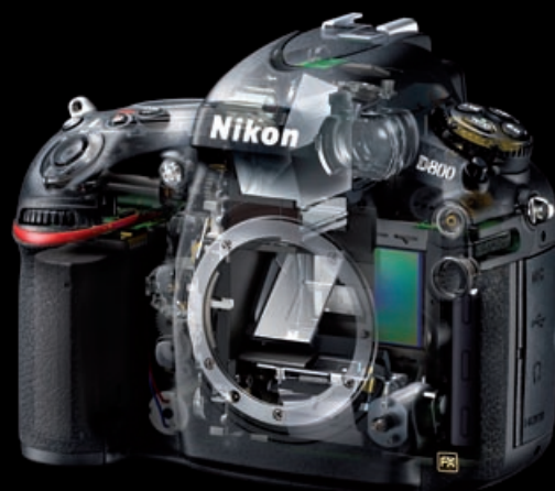
Der Pentaprismensucher verfügt jetzt über eine Bildfeldabdeckung von 100% (D700: 95%) und eine effektive Vergrößerung von 0,70 (0,72).
