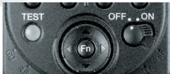
Die Gradangaben auf der Rückseite des Schwenkblitzes zeigen an, wie weit der Blitz gekippt wurde.
